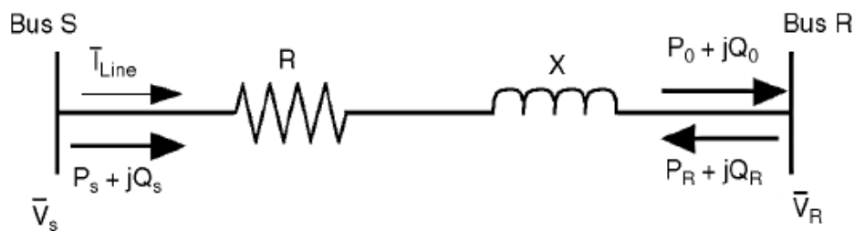
Figura 2.7.1 Línea de Transmisión
